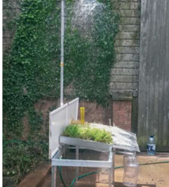
Regnsimulator, der viser hvordan, forskelligt plantedække påvirker jorderosionen ved nedbør.
