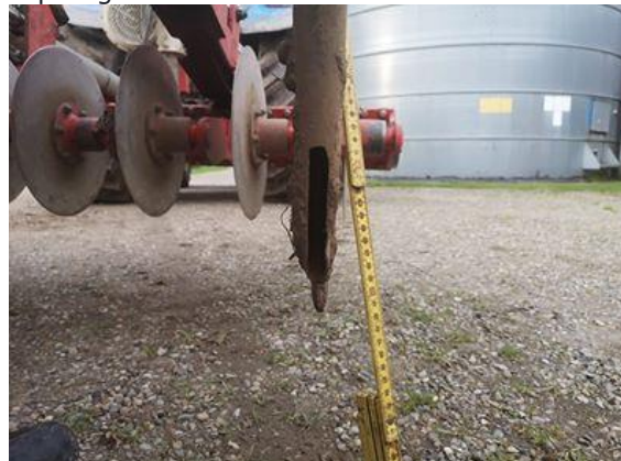
Billede af Metcalf skær (tv) og monteret (th) på Horsch Airseeder CO. Foto: Carl Alfred Carøe
