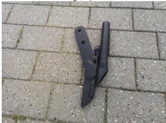
Billede af Metcalf skær (tv) og monteret (th) på Horsch Airseeder CO. Foto: Carl Alfred Carøe
